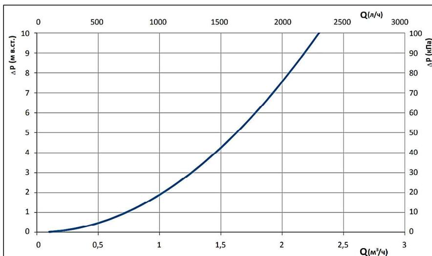
Расчет пропускной способности для узлов, оборудованных насосом рассчитывается отдельно с учетом характеристик насоса. Остаточный напор насоса должен быть достаточен для нормальной циркуляции теплоносителя в системе, в противном случае необходимо изменить режим работы, либо заменить насос на более подходящий по характеристикам, заменить узел с более подходящим размером, оптимизировать систему.
