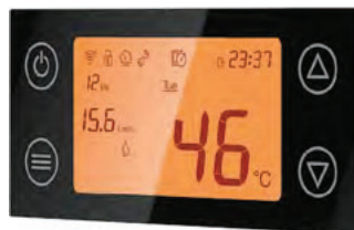
Единая сенсорная панель управления для контуров отопления и ГВС
